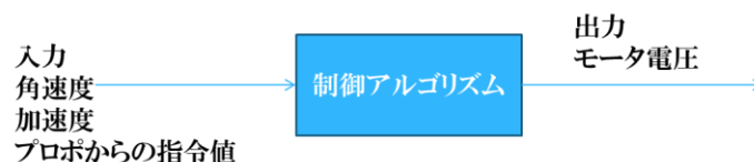
図 5.2 制御アルゴリズムへの入出力をブロック線図で書く場合
