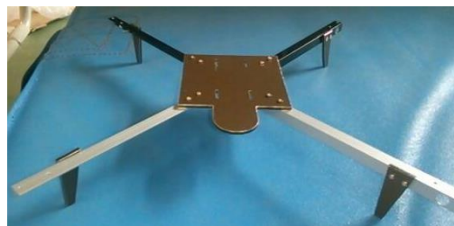
[横国] 中央部・脚：アルミ発泡材ハニカム板 アーム：アルミニウム
