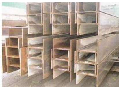
図 4.3 軽量化の例（構造用 H 型鋼）
